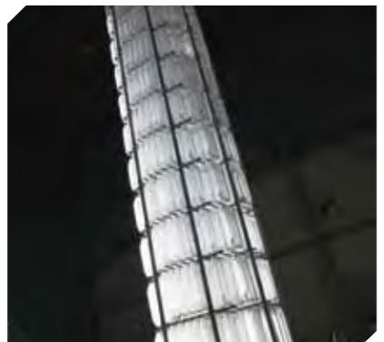
オートクレーブと呼ばれる直径650mm、高さ14mの巨大な圧力容器を用いて高温・高圧下で育成します。人工水晶は1日で0.5mm程度成長する様にコントロールし、2~3か月、長いものでは約6か月の期間を要します。
