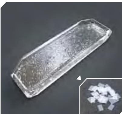
人工水晶を目的に応じた角度で切斷し、目的の周波数に研磨していきます。一つの人工水晶は長辺:約20cm、重さ:約1kgですが、数回の切削、研磨を経て、小さいものでは長辺:約1mm、重さ:数十 $\mu\text{g}$ の水晶晶片が数十万枚切り出されます。
